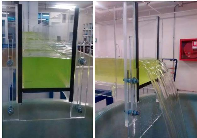
Figura 5.6. Vertedero frontal del canal instalado y funcionando.
