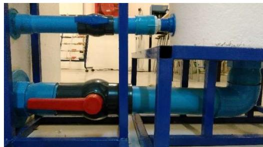
Figura 5.18. Conexión entre el estanque volumétrico y el estanque de almacenamiento.
