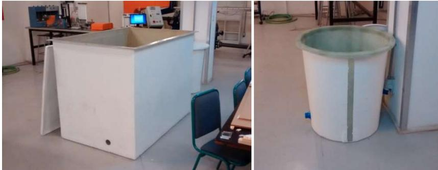
Figura 5.14. Estanques volumétrico y de almacenamiento del canal.
