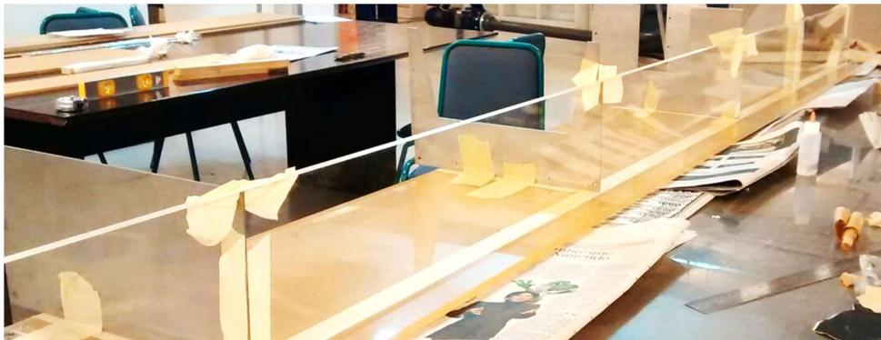
Figura 5.3. Pegado de secciones del canal principal.
