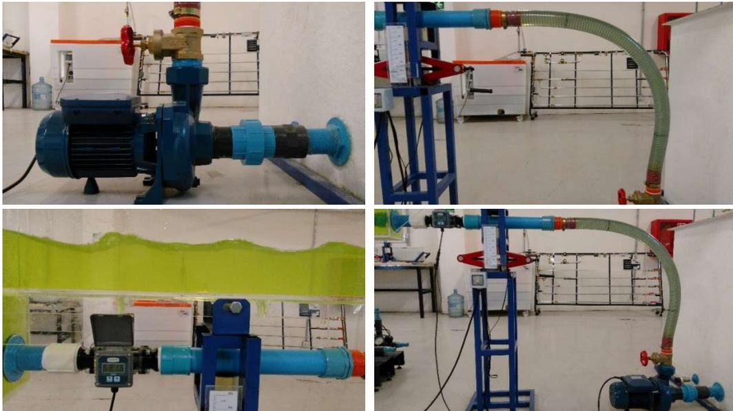
Figura 5.17. Conexión entre el estanque de almacenamiento y el estanque regulador.
