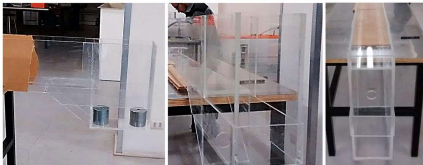
Figura 5.5. Estanque regulador unido al canal principal.
