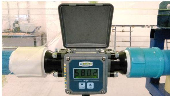
Figura 6.1. Caudalímetro instalado y funcionando, medición del caudal en [L/min].
