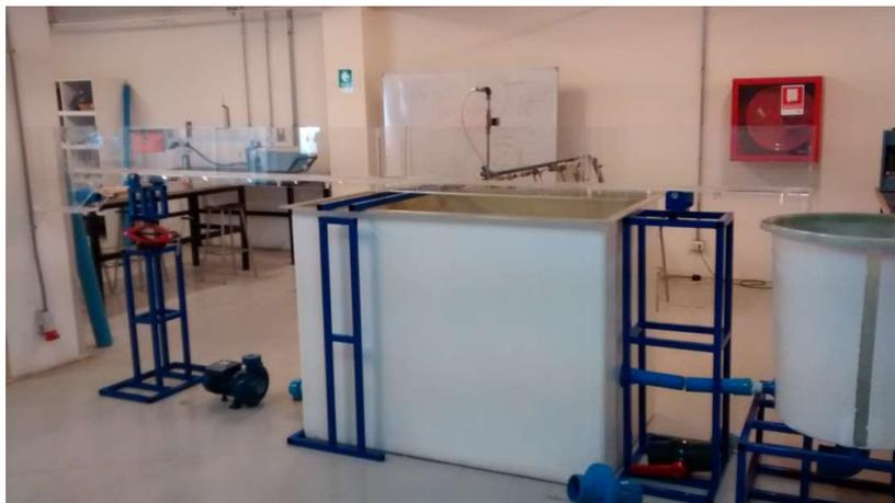
Figura 5.15. Canal ubicado sobre apoyos metálicos y estanque ubicados.
