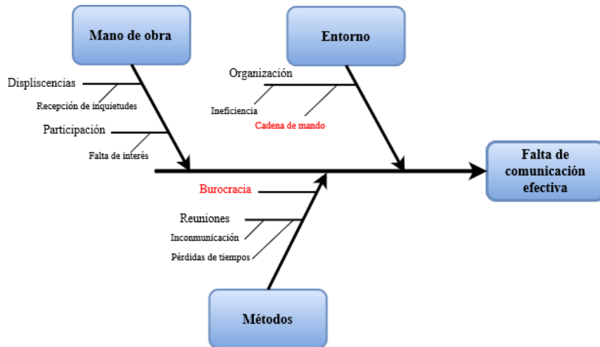
Figura A-1: Diagrama de Ishikawa (espinas de pescado) para falta de comunicación efectiva.
