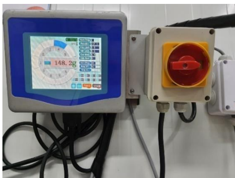
Imagen 5.8 – Tablero máquina envasadora
