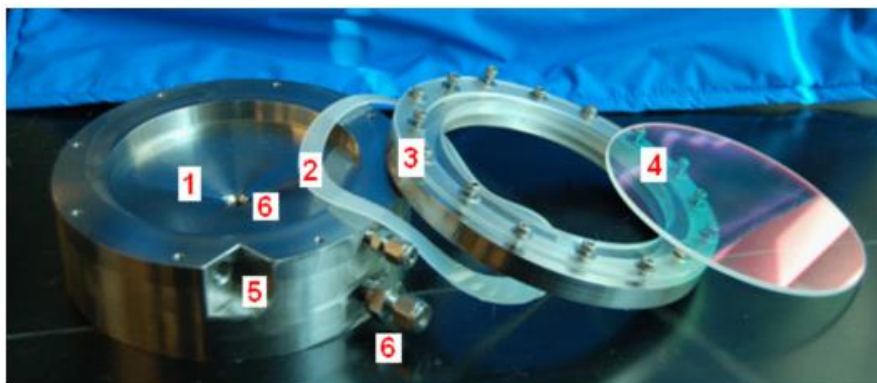
Imagen 2-13: Fotorreactor Tipo II. (1) fotorreactor; (2) empaquetadura; (3) brida; (4) ventana; (5) puerto de entrada; (6) puerto de salida [71].
