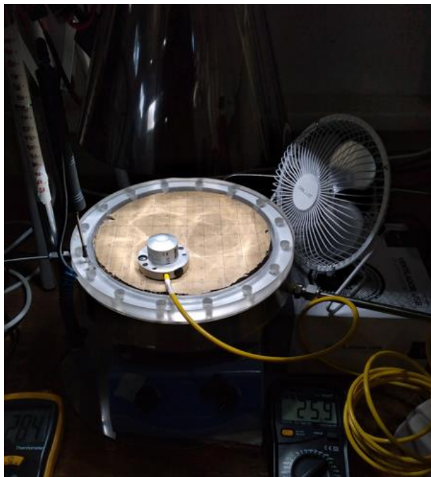
Imagen 5-4: Medición de irradiancia con piranómetro conectado a multímetro sobre ventana de fotorreactor.
