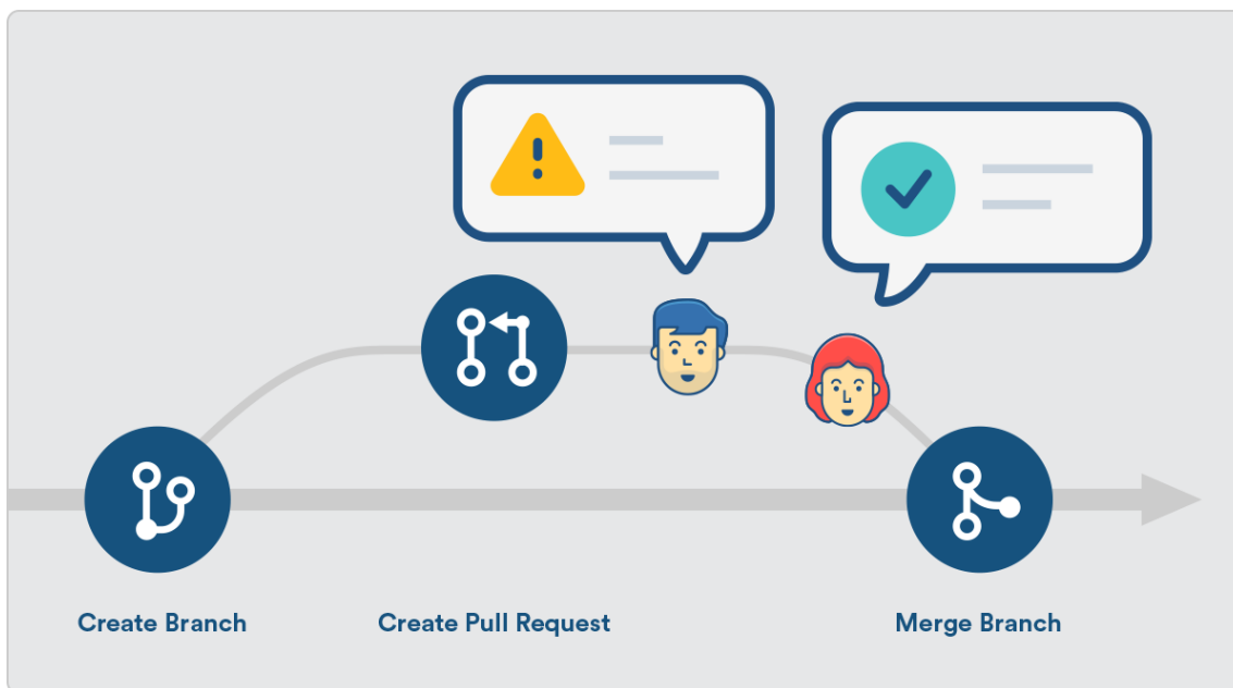
Figura 4: Flujo de trabajo de integración continua (Branching Model). Fuente: Medium
