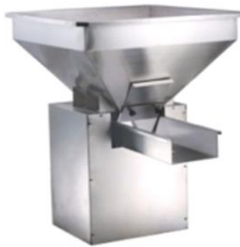
Imagen 2- 37 Tolva de Descarga.
