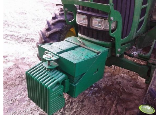
Figura 4: Tractor con lastrado frontal
