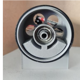
Figura 28: Rueda lastrada unida a motor
