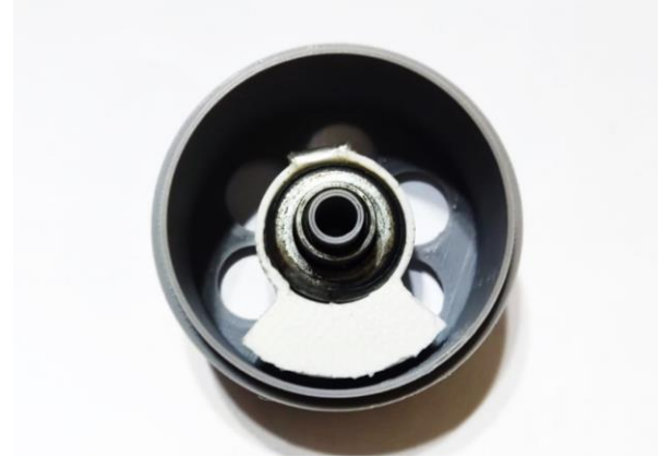
Figura 22: Lastre con forma de cuña
