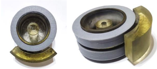
Figura 21: Rueda con rieles en PLA y lastre en resina
