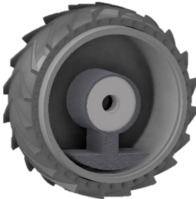
Figura 31: Vista interna de Stabilityre y sus componentes
