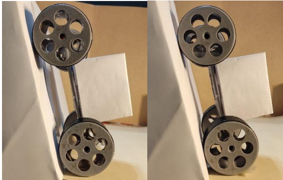
Figura 27: Vehículo con lastre tipo disco y lastre tipo dinámico en roll over
