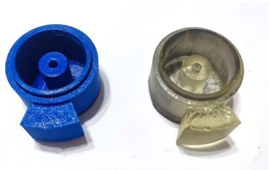
Figura 18: Primera iteración de lastre y llanta en PLA y resina.
