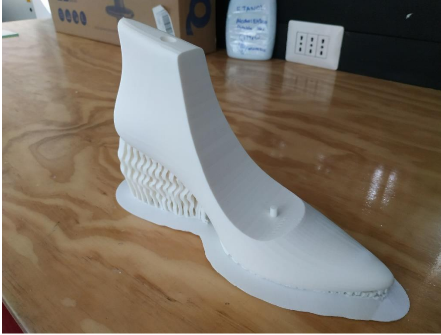
Figura 49: Impresión del prototipo de la pieza base de la horma. Fuente: Elaboración propia
