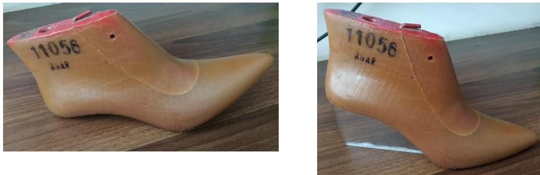
Figura 31: Posición de la horma para escanear: sin soporte (izquierda) y con soporte (derecha). Fuente: Elaboración propia
