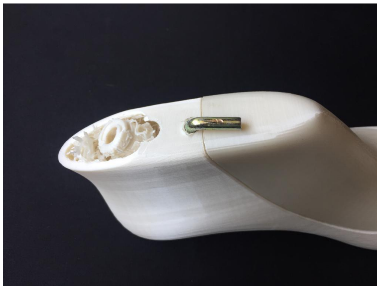
Figura 57: Quiebre zona del orificio de sujeción de la horma. Fuente: Elaboración propia
