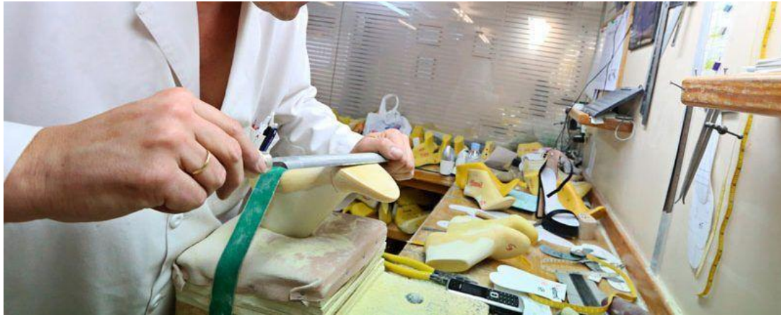
Figura 2: Proceso de fabricación de hormas tradicional (similar al de Calzados IVO). Fuente: sitio web oficial Hormas Beneit.
