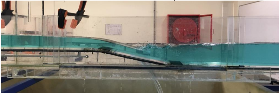
Figura 7.4: Flujo tipo A2, obtenido en laboratorio
