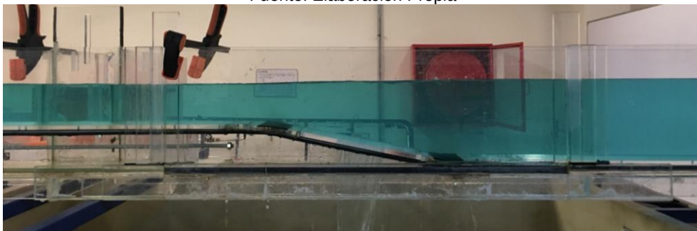
Figura 7.6: Flujo tipo A3, obtenido en laboratorio
