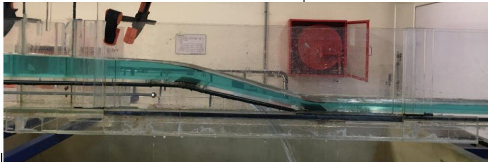
Figura 7.2: Flujo tipo A1, obtenido en laboratorio
