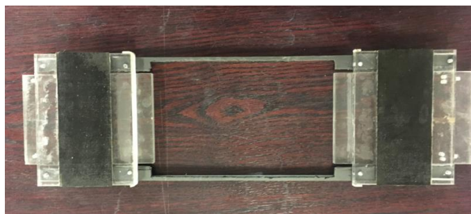
Figura 5.4: Construcción de soporte de rejillas
