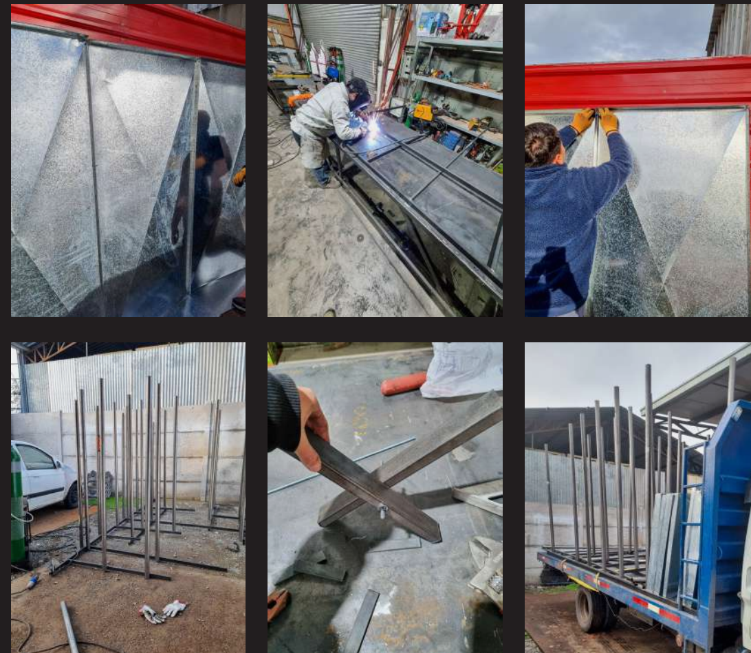
fig. 95. Compilado de fotografías del proceso de prefabricación. Elaboración propia.
