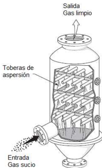
Figura 4.9: Torre de aspersión.
