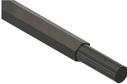
Figura 2-28 Extremo mecanizado del perfil hexagonal.
