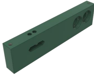
Figura 2-9 Vista isométrica tope lateral.
