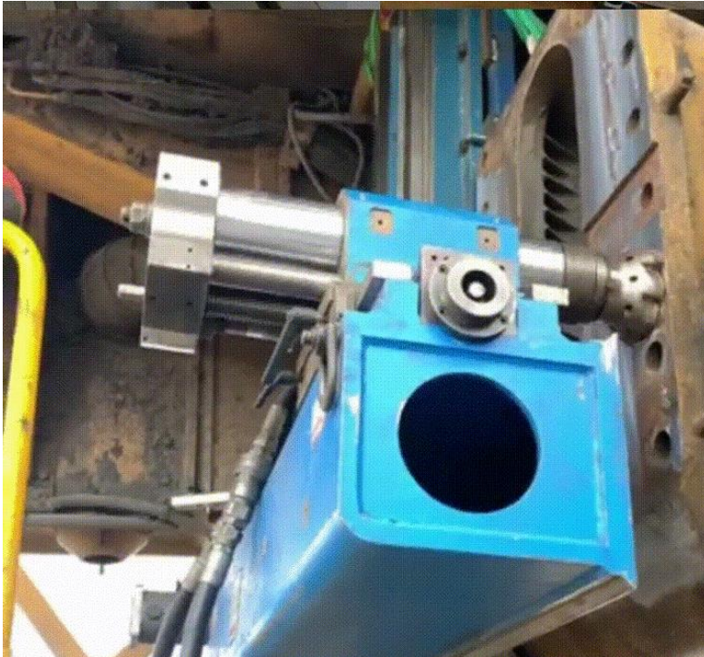
Figura 3-2 Fresado de camión en terreno con fresadora portátil.
