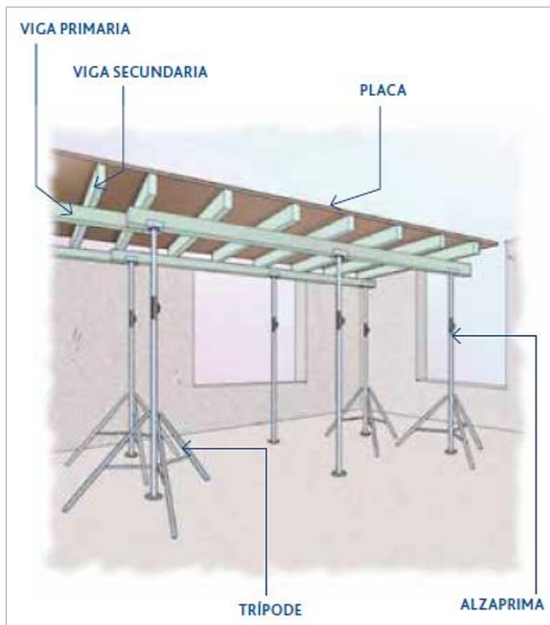
Figura 2-13. Partes de un Moldaje de Losas Fuente: Manual de Moldajes CChC 2014
