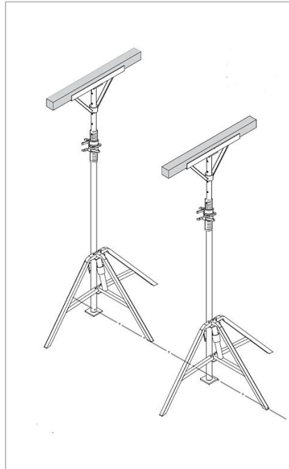
Figura 2-21. Colocación de vigas primarias para Moldaje Viga Fuente: Catálogo Moldajes DOM
