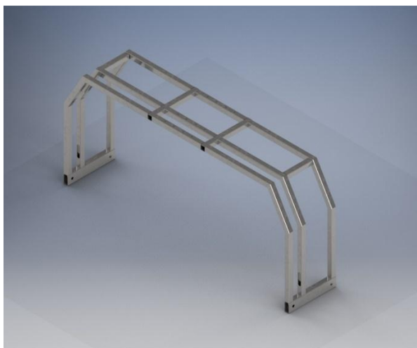
Ilustración 61: Estructura del puente lavador.
