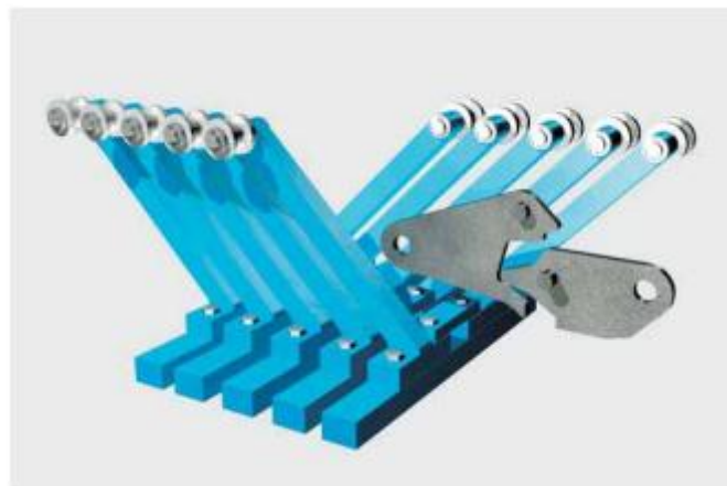
Ilustración 22: sistema de traslado de placas automático una a una
