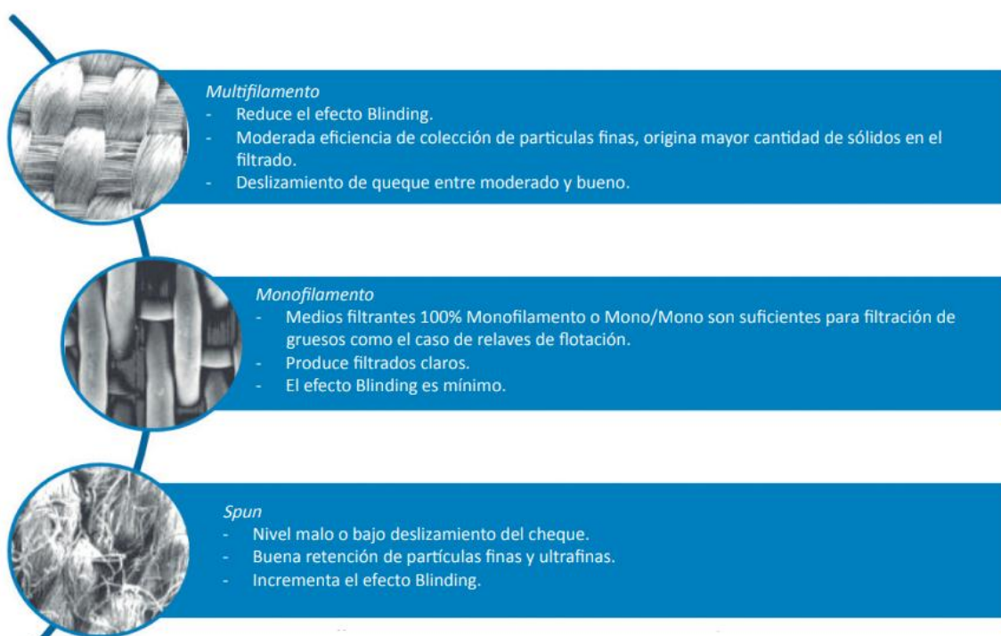
Ilustración 28: Características de los diferentes tipos de medios filtrante.
