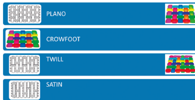
Ilustración 29: Tipos de tramas en la fabricación de medios filtrantes.
