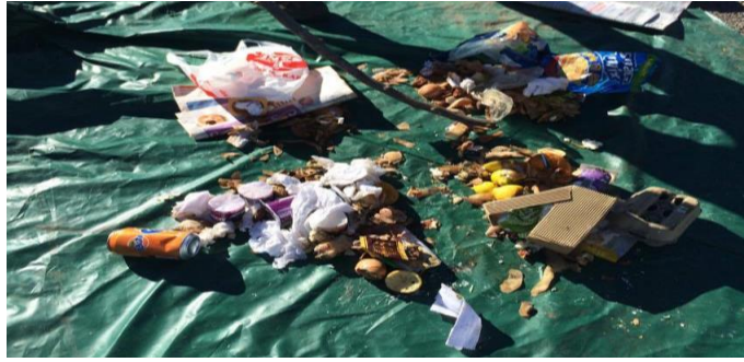
Figura 4.8 Aplicación de método de cuarteo en Putaendo
