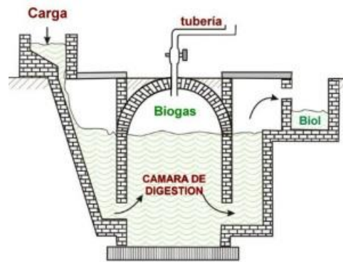
Figura 6.7 Esquema biodigestor tipo chino [41]
