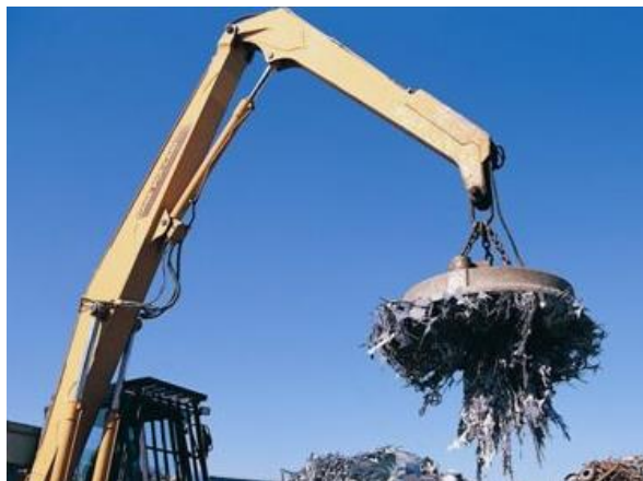
Figura 5.3 Separación magnética de residuos
