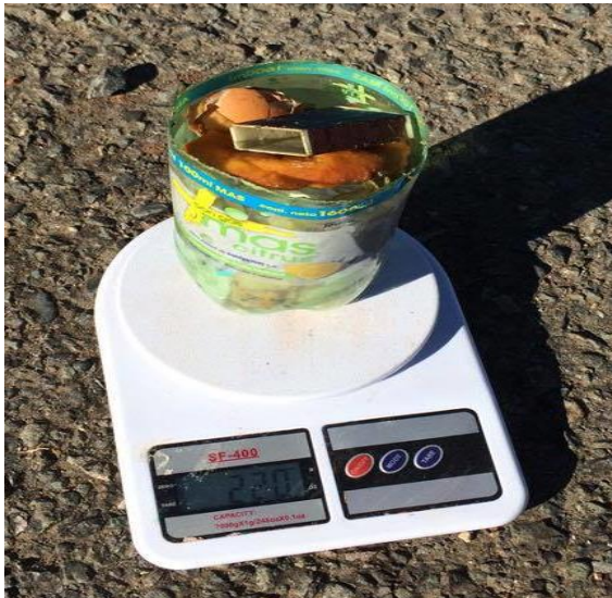
Figura 4.9 Balanza usada para cálculo de densidad de basura
