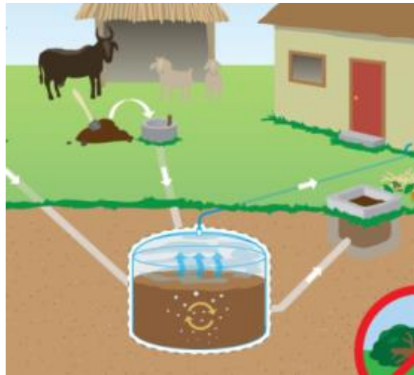
Figura 5.7 Esquema de sistema de digestión anaeróbica
