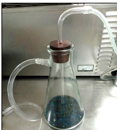
Figura 11: Trampa de vapor
