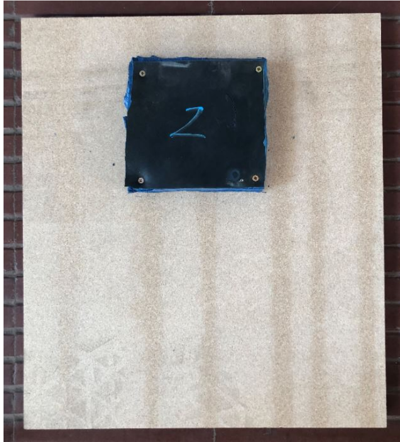
Figura 3.17: Imagen del montaje del caucho sobre la plataforma de pruebas.
