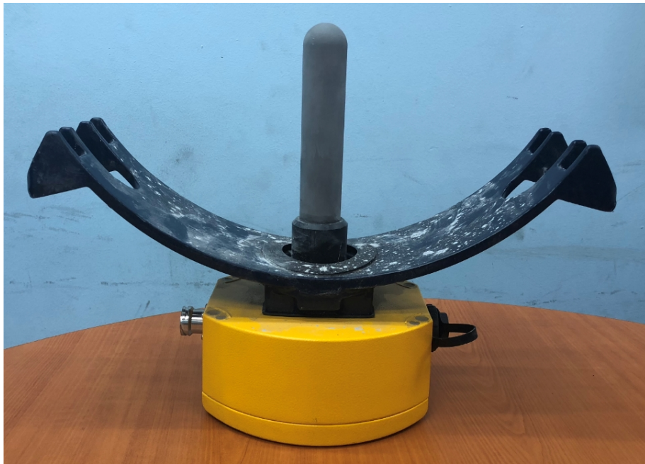
Figura 2.21: Cyclonetrac™ PST . En el cuerpo metálico de color amarillo se encofra la electrónica del dispositivo, mientras que la probeta se encuentra recubierta por caucho de color gris.
