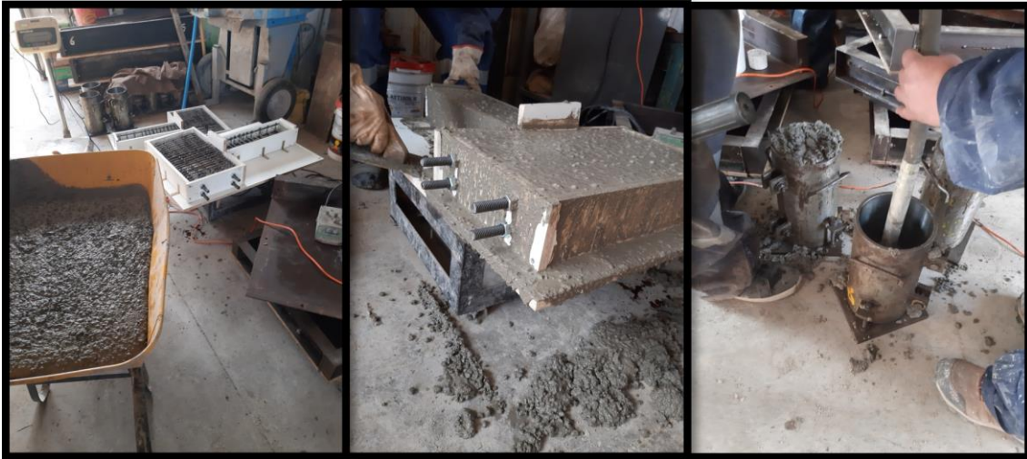
Figura 36 Proceso de hormigonado especímenes, traslado de hormigón a betonera, vibrado y preparación de probetas cilíndricas, de izquierda a derecha
