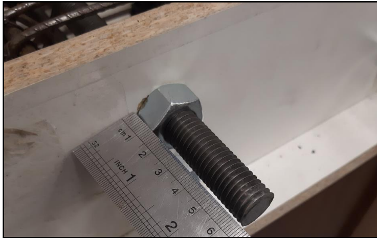
Figura 34 Longitud externa al moldaje de barras roscadas de 6,5 [cm]
