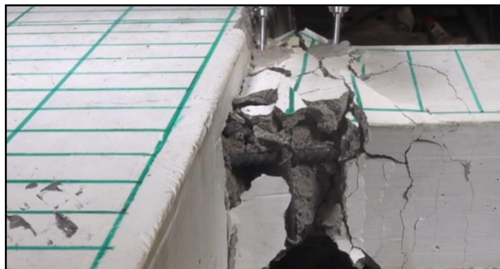
Figura 64 Espécimen RM5 posterior a ensayo de sollicitación sísmica
