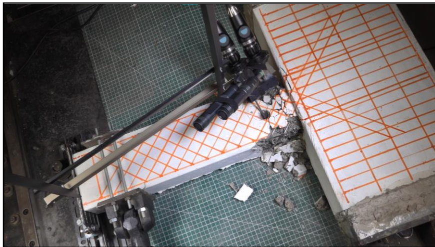
Figura 46 Especimen RM1 posterior a ensayo de sollicitación sísmica
