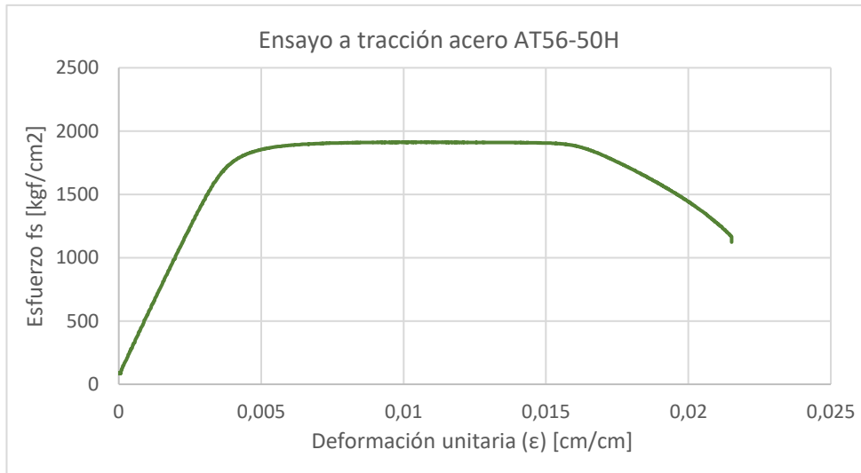
Figura 15 Curva de ensayo tracción para acero AT56-50H
