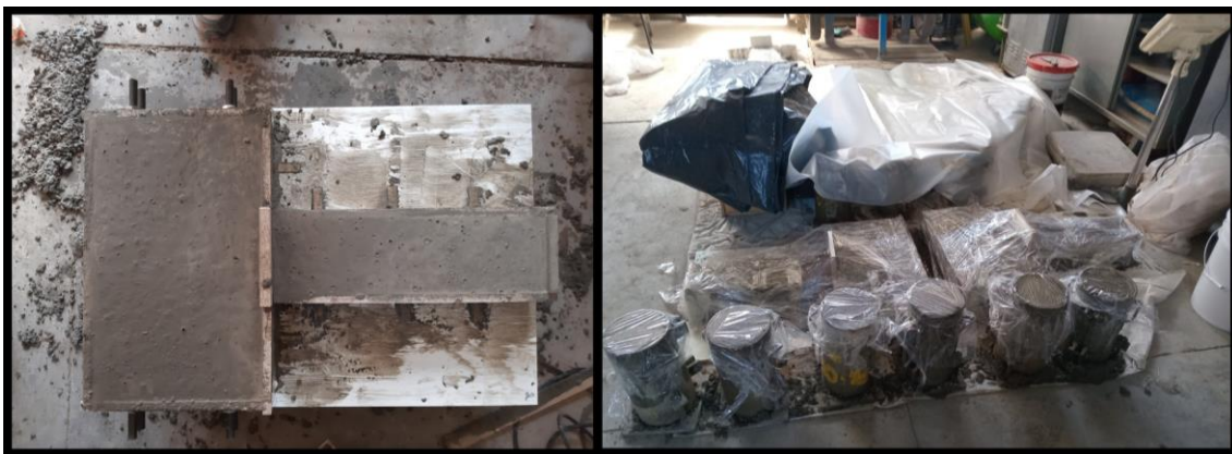
Figura 37 Fin del proceso de hormigonado en probetas cilíndricas y segmentos de marcos estructurales
