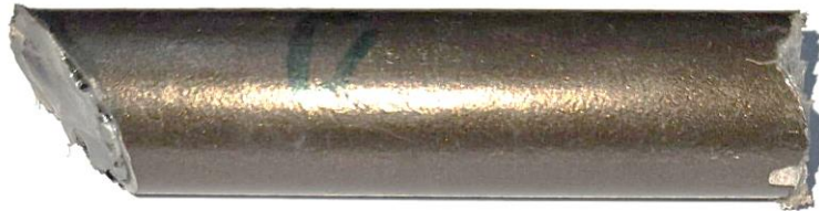
Figura 31 Tubo sellado con silicona en extremo cortado en 60°
