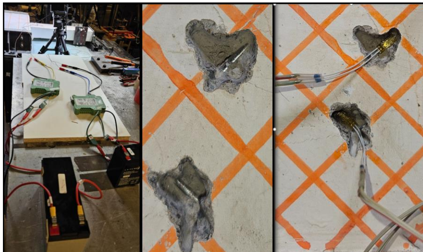
Figura 50 Instalación de galgas extensiométricas en estribos inclinados de espécimen RM2
