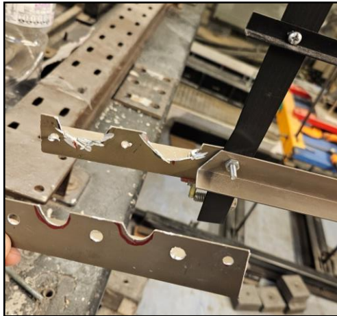
Figura 87 Placas con cavidades para encaje de cámaras endoscópicas
