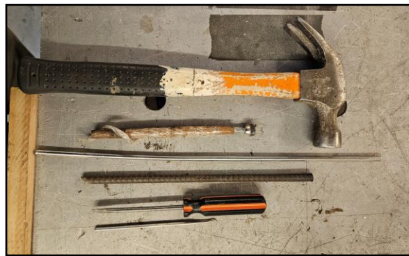
Figura 85 Herramientas utilizadas para limpieza de barras longitudinales
