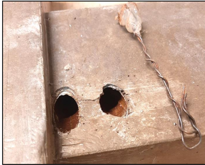
Figura 30 Tapón de silicona retirado posterior al hormigonado de la probeta
