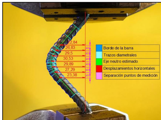
Figura 7 Pandeo de barras por fatiga de bajo ciclaje, sin restricción
