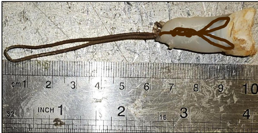
Figura 29 Tapón de silicona utilizado para sellar el extremo del tubo en contacto con el refuerzo longitudinal
