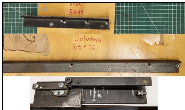
Figura 84 Bases para doblado del acero, correspondientes a estribos ortogonales de viga, de columna y estribos inclinados en dos planos para viga, de arriba hacia abajo
