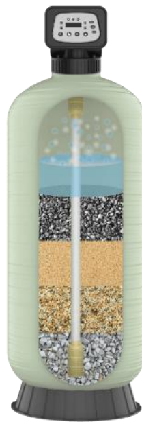
Imagen N° 2 “Sistema Filtración Multimedia” (El sistema de filtro multimedia reduce el nivel de SDI y TSS. (2021)
