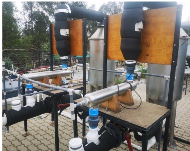
Figura 4-7 Planta HDH de dos etapas.
