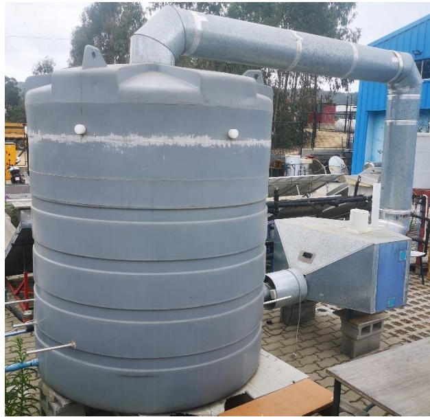
Figura 4-1 Planta HDH de una etapa.
