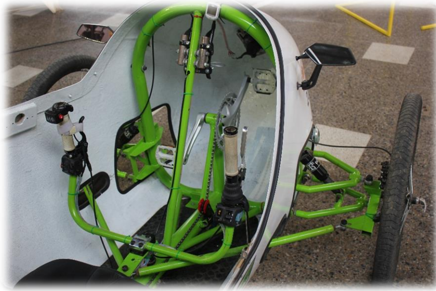
Ilustración 10: Vista del sistema de mandos laterales como parte del sistema de dirección
