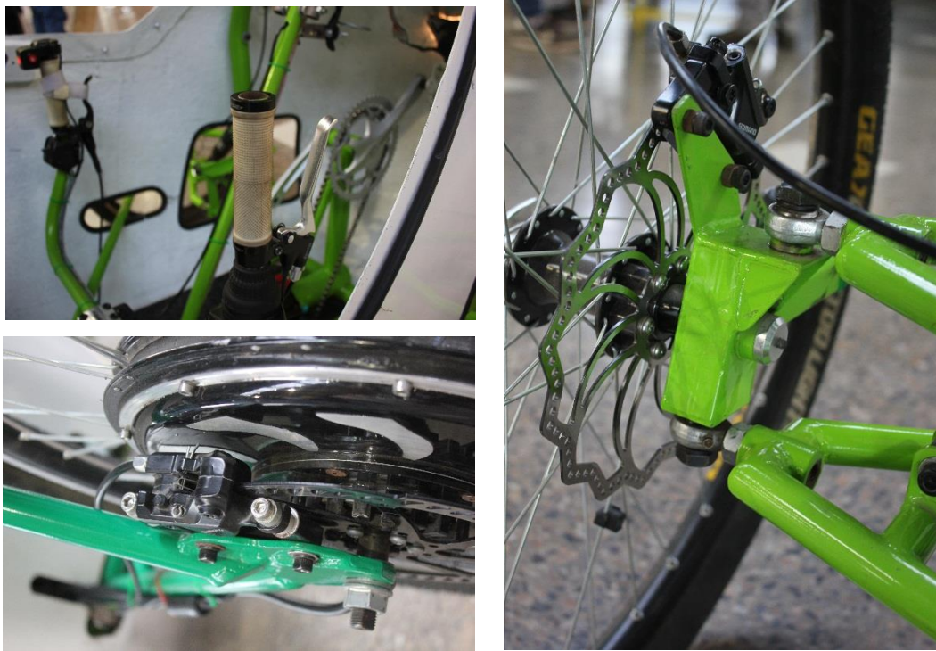
Ilustración 12: Disposición de las manillas de frenos, caliper y frenos de disco.
