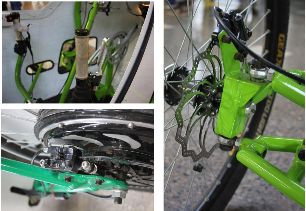
Ilustración 1: Disposición de las manillas de frenos, caliper y frenos de disco.
