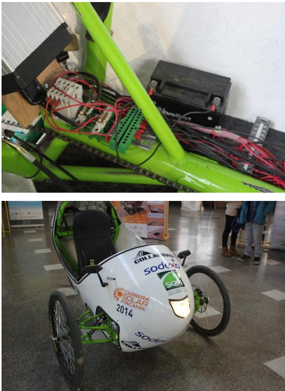
Ilustración 13: Conexiones de las luces delantera y trasera a la batería auxiliar de 12 [V]
