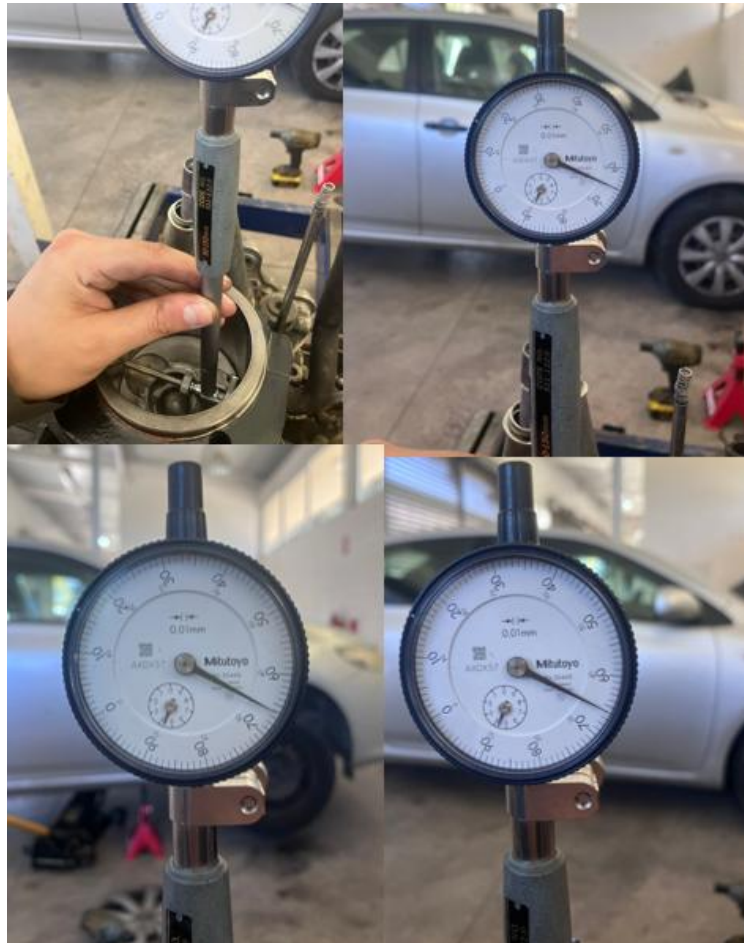
Figura 9: Toma de mediciones del estado interno del cilindro.
