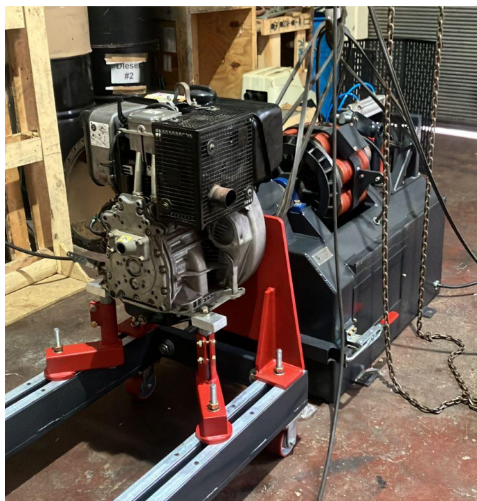
Figura 15: Presentación preliminar conjunto freno-motor.
