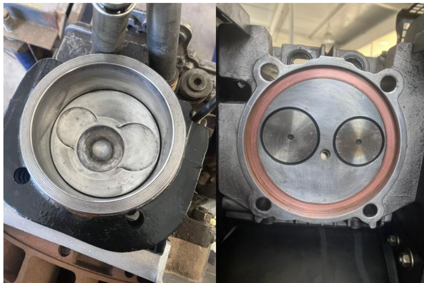
Figura 7: Limpieza de culata, camisa y cabeza de pistón.
