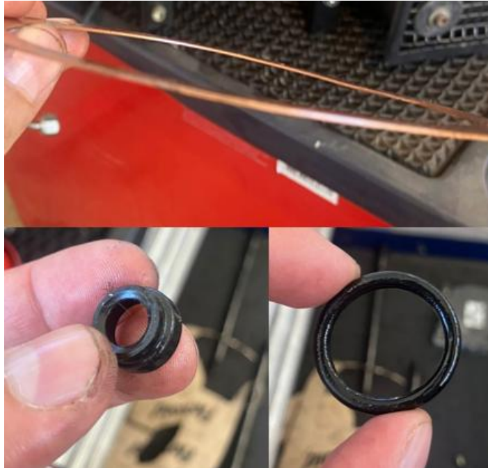
Figura 8: Estado empaque de culata, anillos tóricos y retenes.
