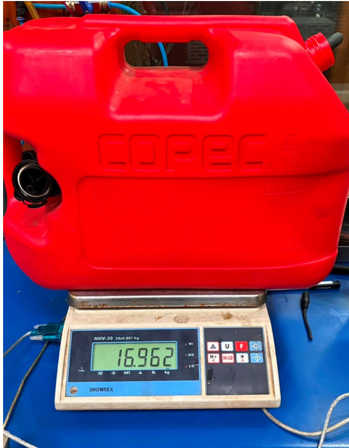
Figura 21: Método gravimétrico para consumo específico de combustible.
