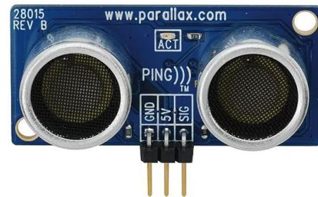
FIGURA 13: Sensor ultrasónico PING))).
