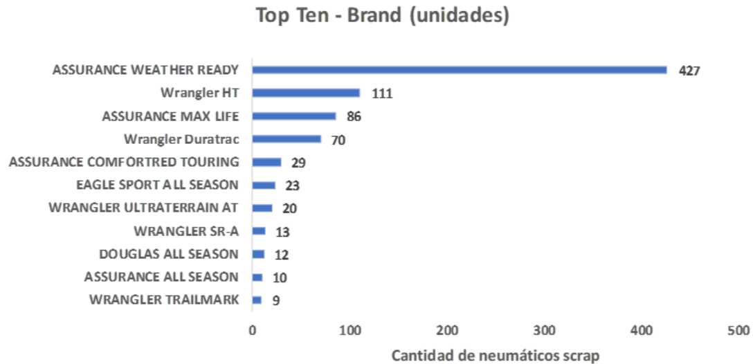
Figura 9 Diagrama de Pareto con las 10 principales familias de neumáticos por fuera de balanceo estático. (Fuente: Elaboración propia mediante software Microsoft Excel 365.)
