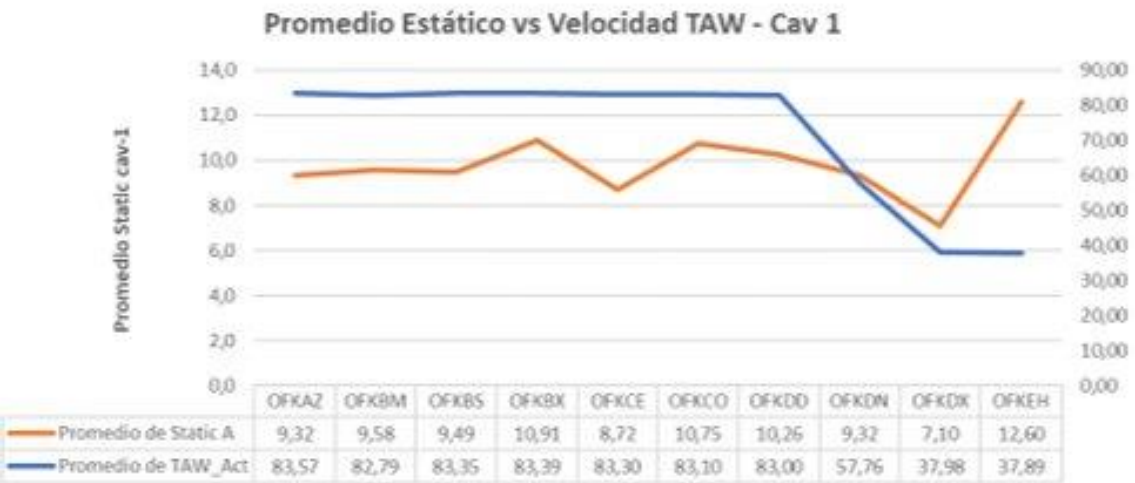
Figura 18 Promedio de Balanceo estático en extrusión de banda de rodamiento en función a la velocidad de línea de conveyor (Fuente: Elaboración propia mediante software Microsoft Excel 365).
