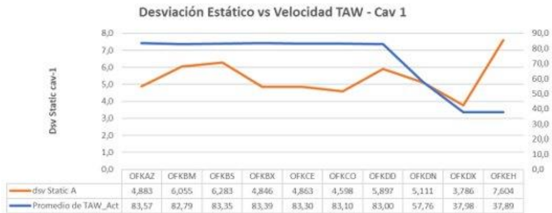
Figura 19 Desviación estándar en extrusión de banda de rodamiento en función a la velocidad de línea de conveyor (Fuente: Elaboración propia mediante software Microsoft Excel 365).
