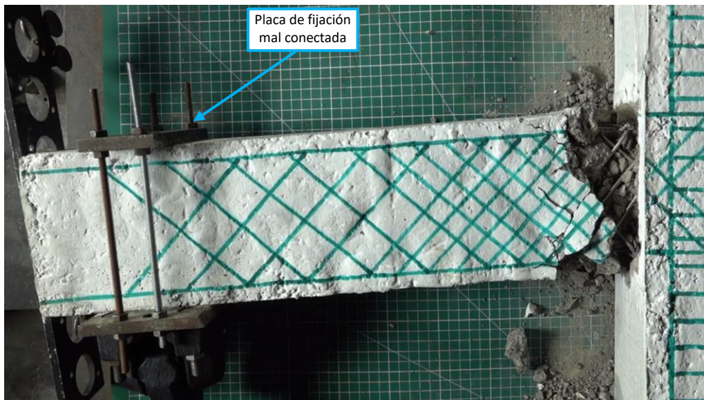
Figura 52. Torsión de probeta GJ1 - Quinto ciclo de amplitud de 35 [mm]
