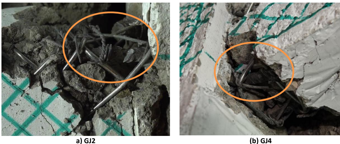
Figura 82. Rotura del refuerzo longitudinal en probetas
