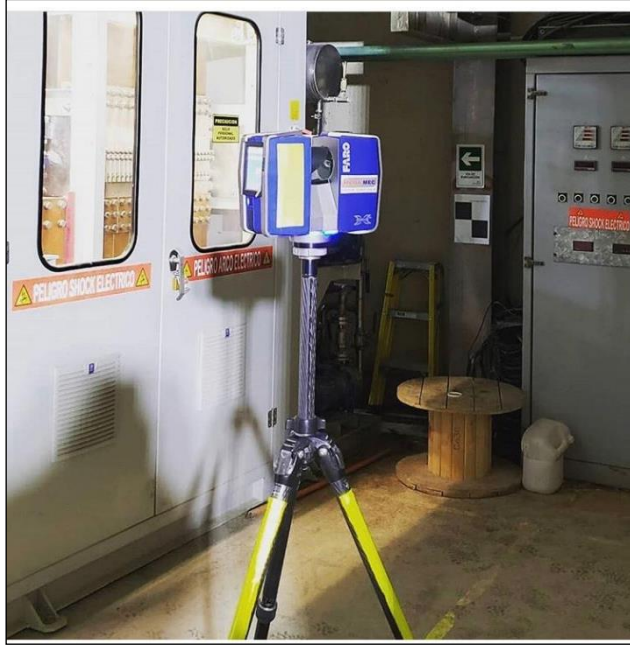
Figura 1-6. Montaje del scanner en altura
