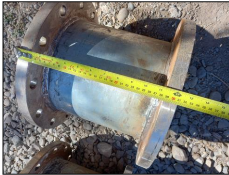
Figura 1-5. Tubo brida brida.
