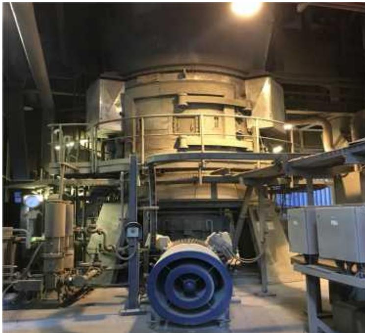
Figura 3- 9: Molino de carbón
