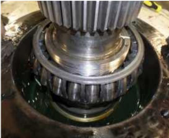
Figura 3- 12 Componente dañado
