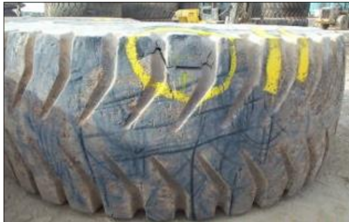
Figura 16: Neumático con corte en la banda de rodamiento. (Morales, 2020).
