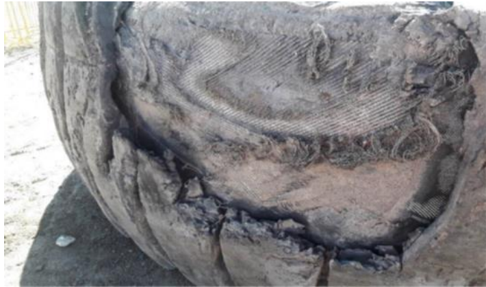
Figura 17: Neumático con separación por calor. (Morales, 2020).
