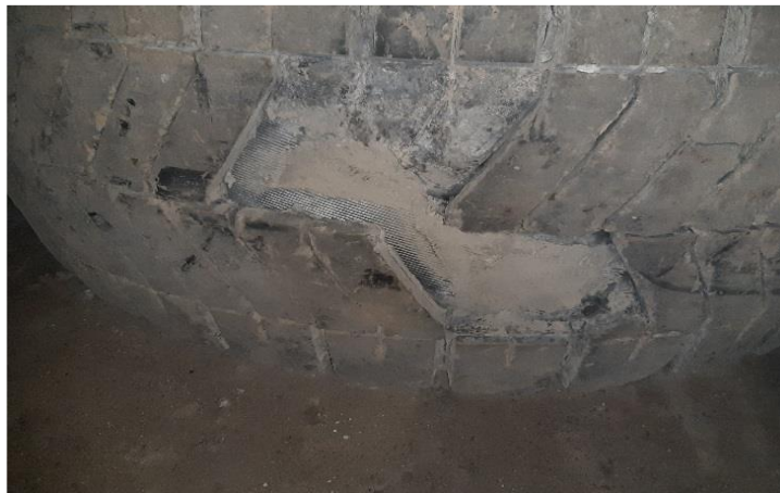
Figura 18: Neumático con separación mecánica. (Morales, 2020).
