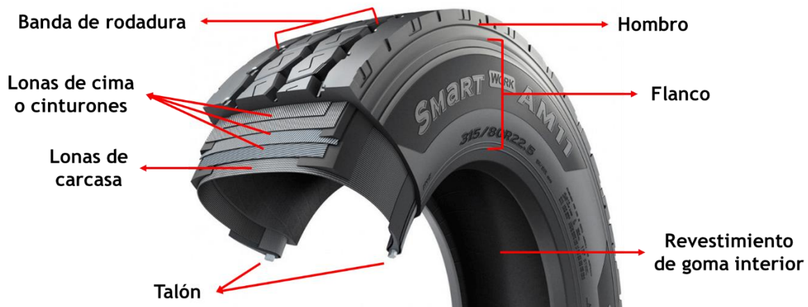
Figura 7: Componentes de un neumático.
