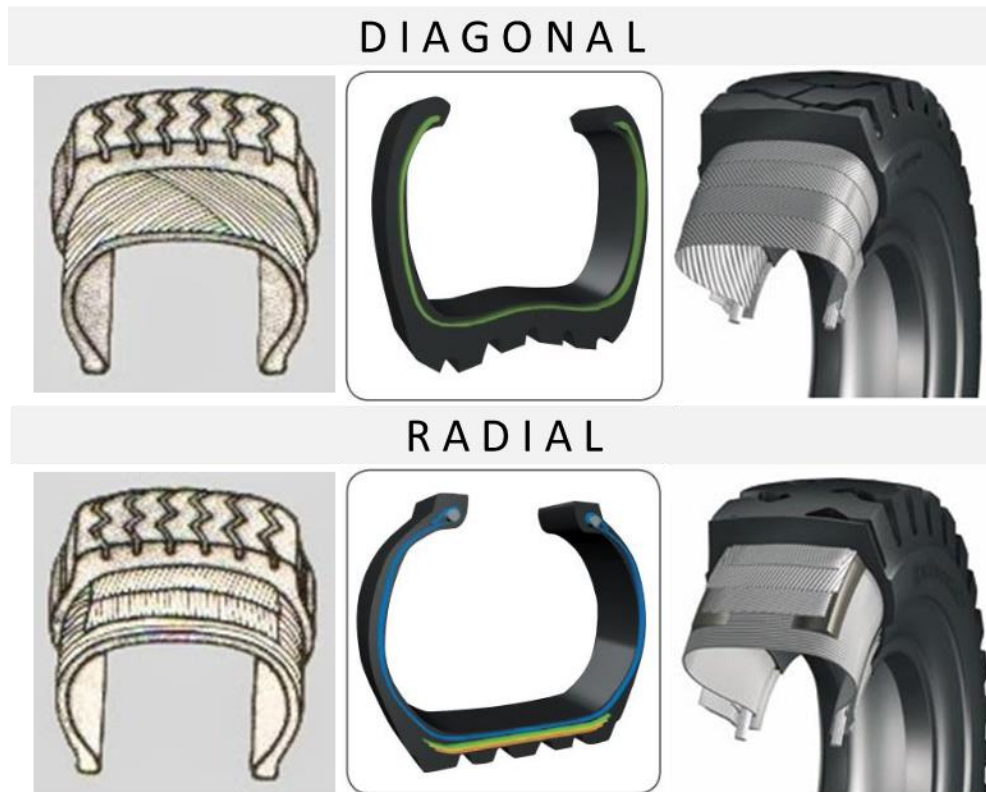
Figura 9: Diferencias entre neumáticos diagonales y radiales.
