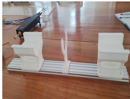
Figura 7.14: Último banco de pruebas creado para la implementación del método de espacio libre para las bandas V y W
