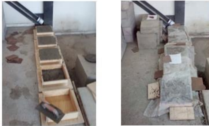
Ilustración 8 - Relleno y curado de moldajes
