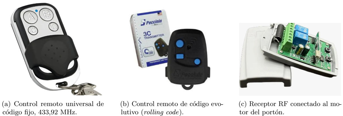
Figura 3.1: Componentes del sistema de control de acceso por radiofrecuencia (RF) en portones residenciales: (a) control de código fijo [3]; (b) control de código evolutivo [4]; (c) receptor RF [5].
