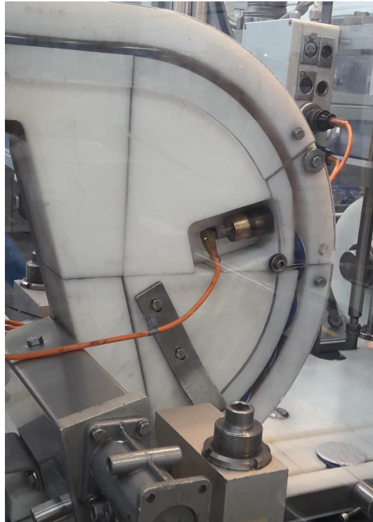
Figura 3-6: Sección de tapadora sin tapas debido al inadecuado empuje de estas
