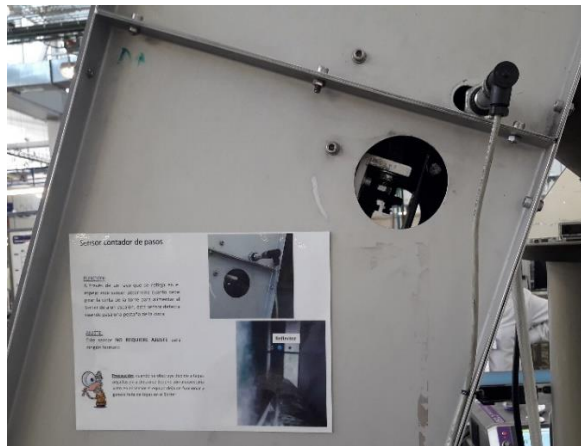
Figura 6-6: Sensor en nueva posición junto con su instructivo
