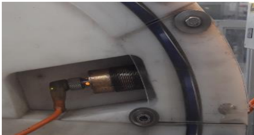
Figura 4-1: Sensor inductivo ubicado en la tapadora
