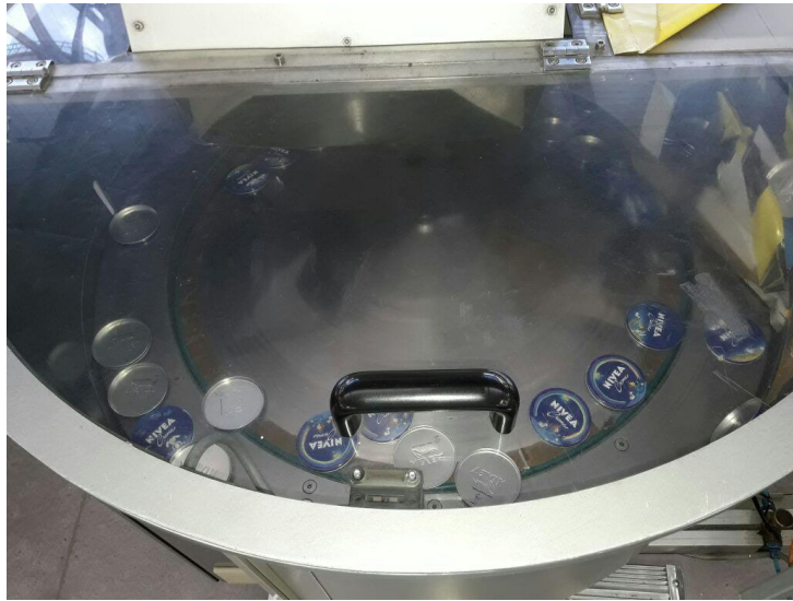
Figura 6-2: Funcionamiento del "sorter" posterior a la restauración de condiciones básicas
