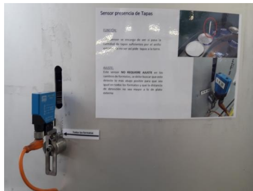
Figura 6-4: Gestión visual e instructivo para el sensor solicitante de tapas
