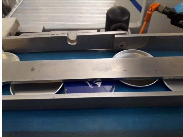
Figura 3-4: Tapa en posición incorrecta dentro del transporte de tapas
