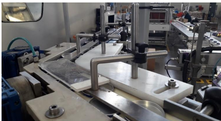
Figura 6-8: Nuevo sistema de ajuste de guías para las tapas que no requiere herramientas
