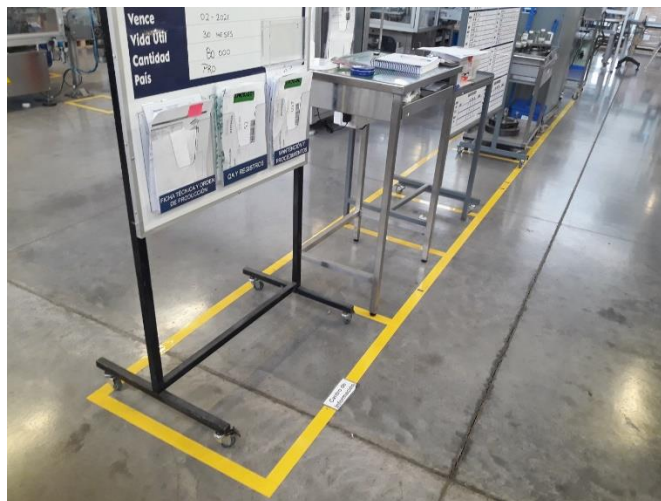
Figura 6-18: Demarcación de diferentes partes de la línea de envasado
