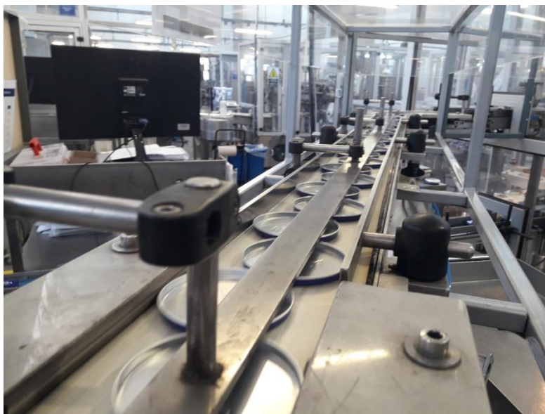
Figura 2-27: Cinta de acumulación e ingreso de tapas
