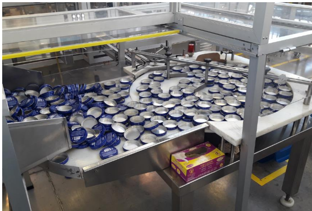
Figura 2-7: Mesa giratoria encargada de la alimentación de fondos
