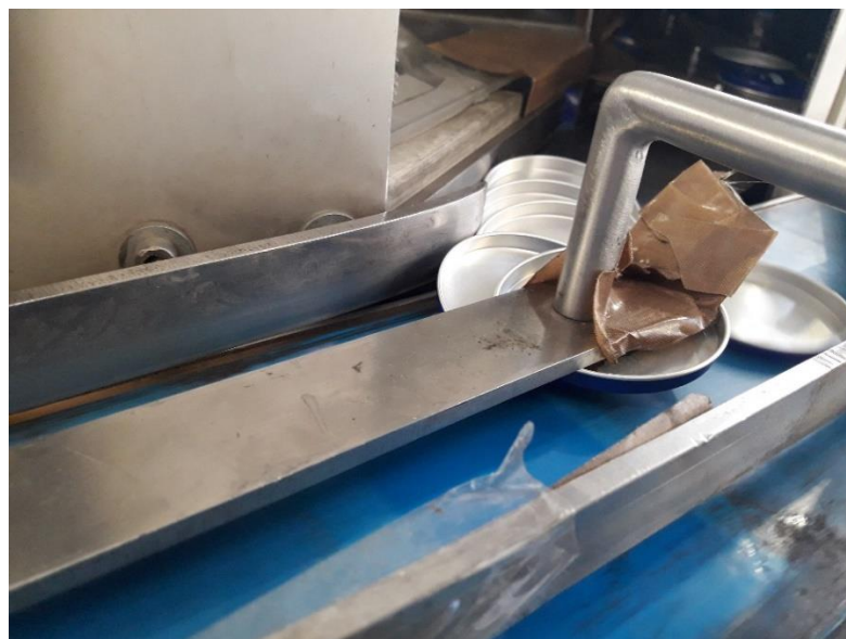
Figura 3-5: Atasco de tapas a la salida del "sorter"
