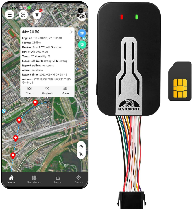
Figura 2.9: GPS Tracker 4G LTE de Microlab con app BAANOOL IoT
