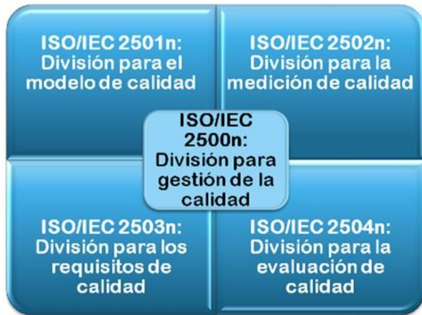
Figura 2: Este esquema muestra las secciones del estándar ISO/IEC 2500, indicando a que se especifica cada una.
