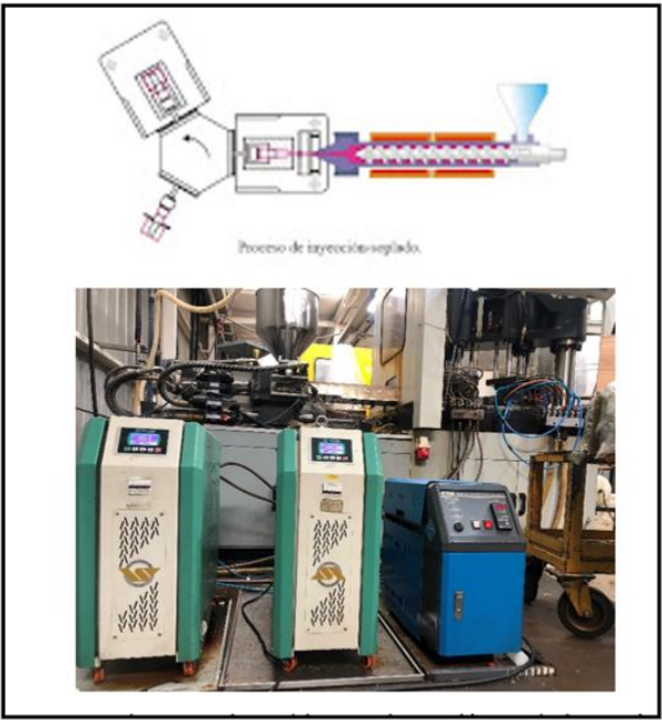
Figura 1-5. Diagrama de moldeo por inyección soplado y máquina.
