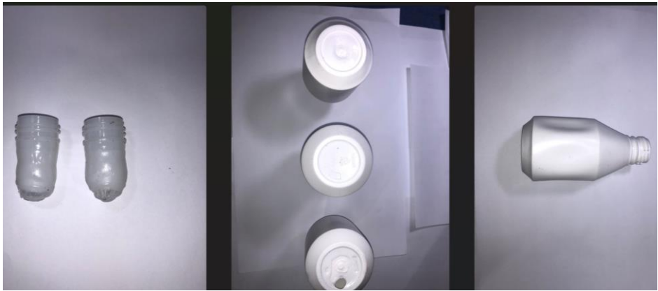
Figura 1-6. Producto no conforme debido a la falta de un equipo MTC.
