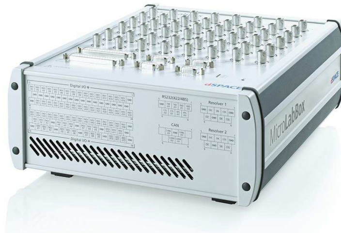
Figura 6.1: Equipo MicrolabBox en donde se procesan las señales para la implementación de los controladores.
