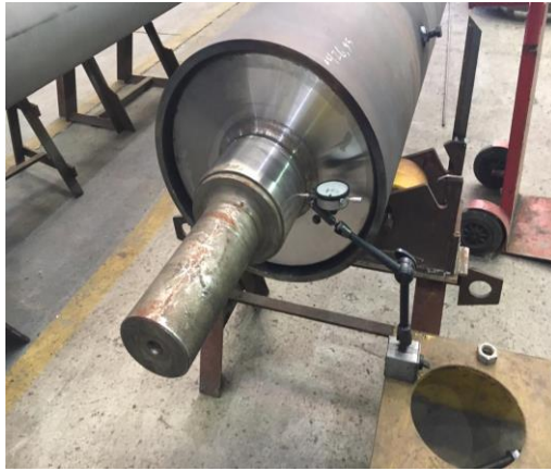
Ilustración 2-5: Alineamiento con reloj comparador. Fuente: propia.
