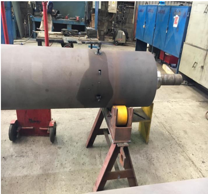
Ilustración 2-6: Soldadura de tapón para el eje. Fuente: propia.
