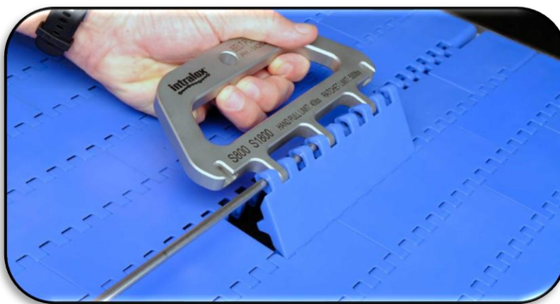
Figura II-7: Ejemplo de pasador de acero con manilla para manejo y división de cinta modular.
