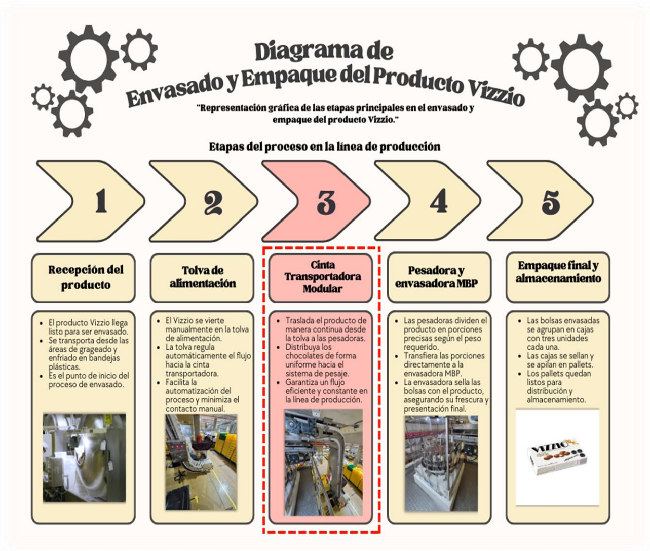
Fuente: Elaboración propia en base a fotografías reales de la Máquina envasadora MBP. Figura I-6: Diagrama de Envasado y Empaque del Producto Vizzio.
