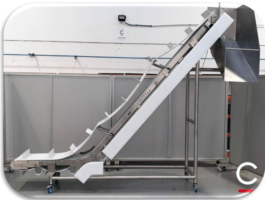
Figura II-3: Representación de un sistema con mejoras en soportes y estructura de la cinta modular
