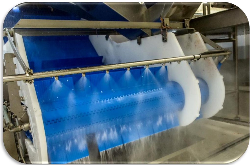
Figura II-4: Sistema de limpieza automatizado para cintas transportadoras
