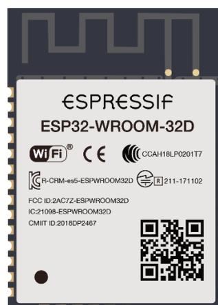
Figura 2-4: Modulo WiFi con ESP32
