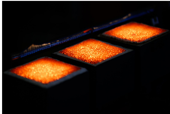
Figura 2.10: Quemador poroso formado por espuma cerámica.
