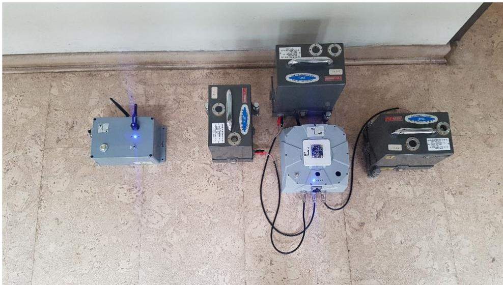
**Figura 7-10:** Despliegue de equipos de medición en edificio P: (izquierda) instrumentación inalámbrica de bajo costo; (derecha) sismógrafos comerciales
