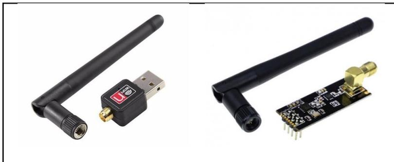
**Figura 5-6:** Conexión inalámbrica: Modulo Wifi (Izquierda), Modulo RF (Derecha)
