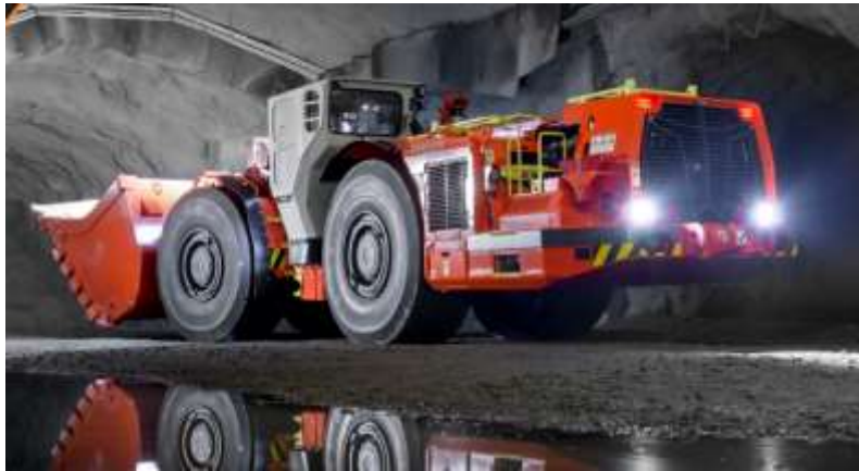
Figura (Anexo C) 1. Equipo LHD Sandvik Toro LH517i
