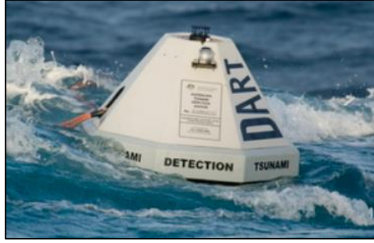
Figura 2. Boya del sistema DART utilizada para el monitoreo de tsunamis mediante sensores de presión en aguas profundas. Fuente: PMEL/NOAA.
