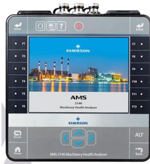
Figura 7: Equipo analizador de vibraciones
