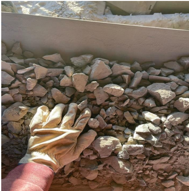
Figura 3-20: Producto de descarga con P80 favorable en cinta S-4 en proporción con mano del operador.
