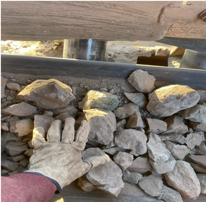
Figura 3-19: F80 de alimentación en cinta auxiliar 2 favorable para el equipo y en proporción con mano del operador
