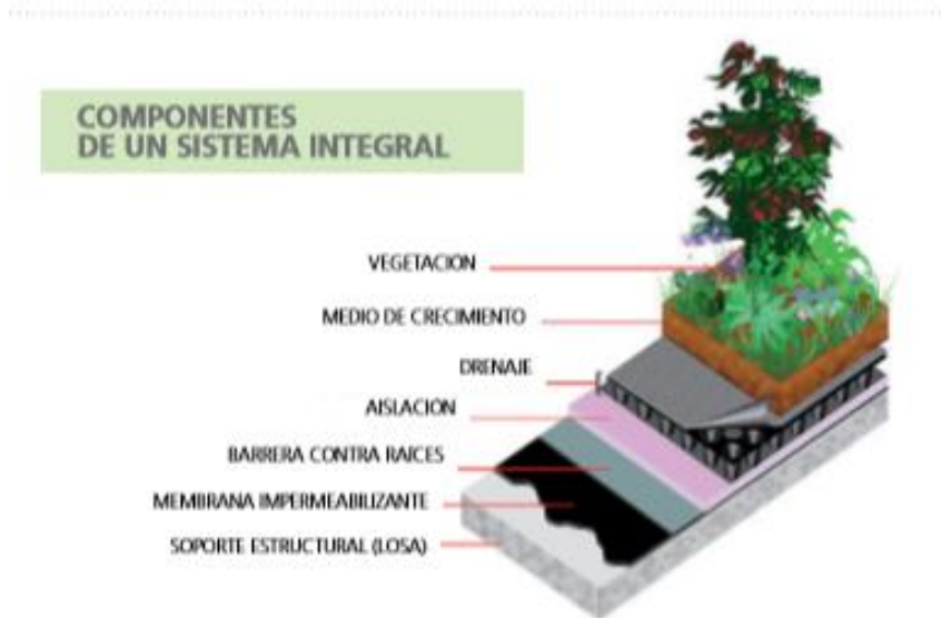
Figura 6: Componentes Cubierta Vegetal, (Maldonado, 2008)
