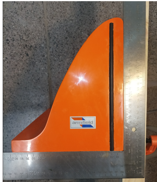
Figura 4.9: Vertedero tipo Ogee S6-23 Fuente: Laboratorio UTFSM campus San Joaquín
