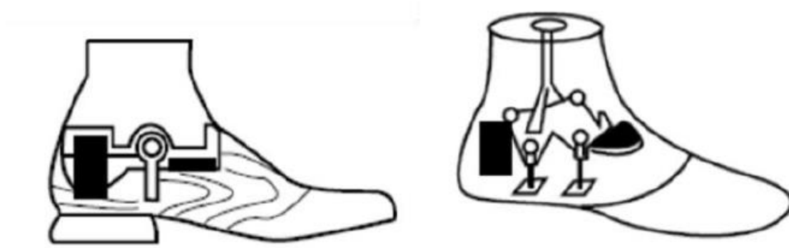
Figura 3.9 Pies articulados de eje simple y de multieje [12].
