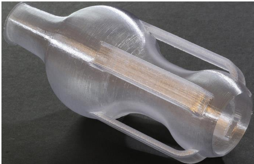
Figura 3.12 Pieza impresa en PETG [16].
