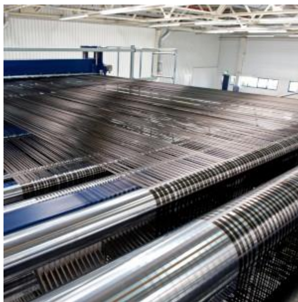
Figura 0.11 Proceso de hilado para la fabricación de fibra de carbono [28].
