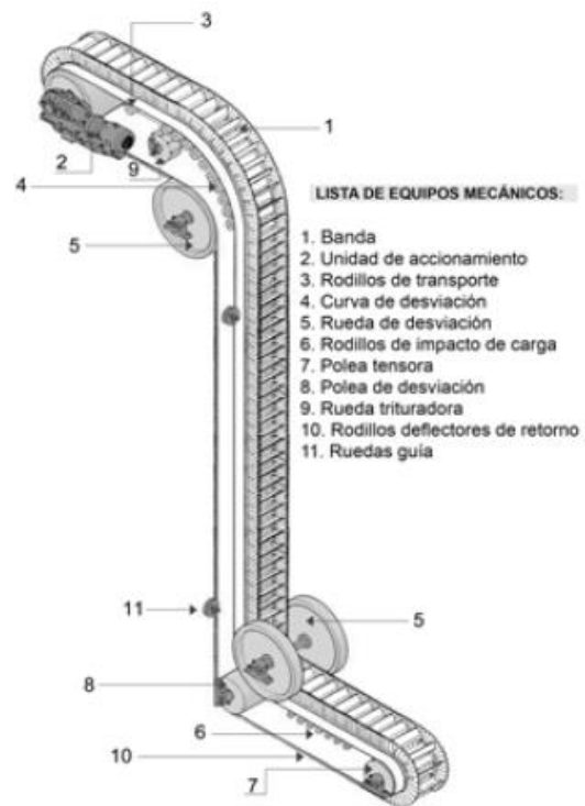
Figura 3-6: Pockit belt típico para elevación vertical [19].
