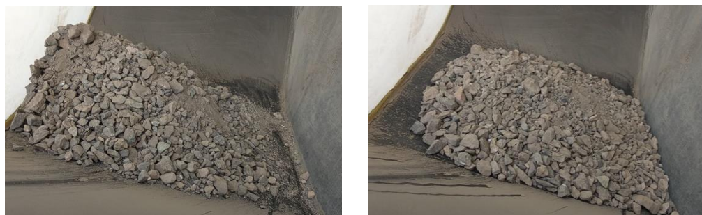
Figura 6-18: Ensayo de ángulo máximo de inclinación para el mineral chancado de cobre. Inclinación de 16° para 2 m/s y 250 m de longitud.
