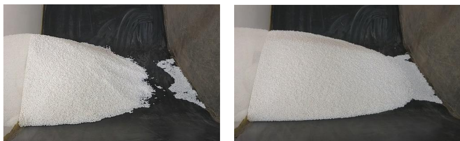
Figura 6-12: Ensayo de ángulo máximo de inclinación para el fertilizante. Inclinación de 7^{\circ} para 3 m/s y 400 m de longitud.
