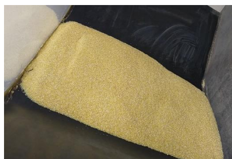
Figura 6-5: Ensayo de ángulo máximo de inclinación para el grits de maíz. Inclinación de 22^\circ para 2 m/s y 250 m de longitud.
