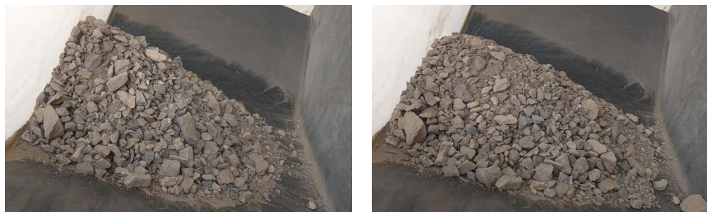
Figura 6-17: Ensayo de ángulo máximo de inclinación para el mineral chancado de cobre. Inclinación de 15° para 2 m/s y 250 m de longitud.
