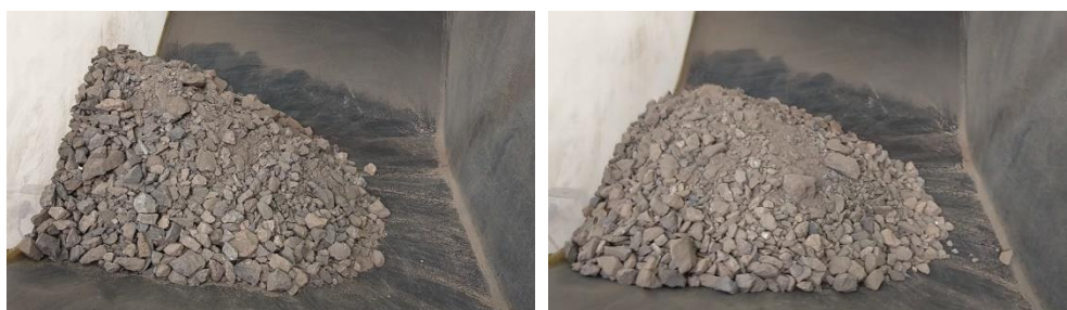
Figura 6-19: Ensayo de ángulo máximo de inclinación para el mineral chancado de cobre. Inclinación de 6° para 3 m/s y 400 m de longitud.
