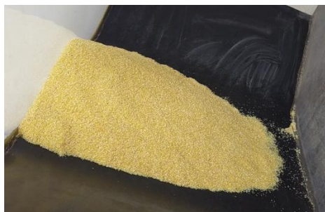
Figura 6-4: Ensayo de ángulo máximo de inclinación para el grits de maíz. Inclinación de 21^\circ para 2 m/s y 250 m de longitud.
