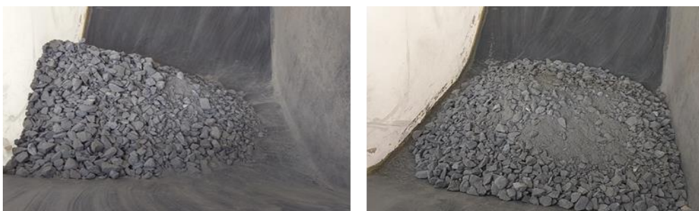
Figura 6-27: Ensayo de ángulo máximo de inclinación para el mineral chancado de hierro. Inclinación de 8^\circ para 3 m/s y 400 m de longitud.
