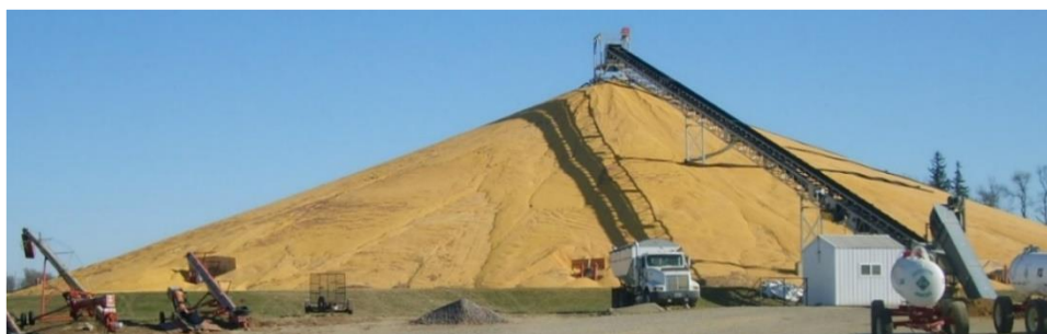
Figura 3-8: Ángulo de reposo de una pila de maíz [22].
