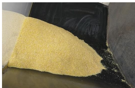
Figura 6-7: Ensayo de ángulo máximo de inclinación para el grits de maíz. Inclinación de 16^\circ para 3 m/s y 400 m de longitud.
