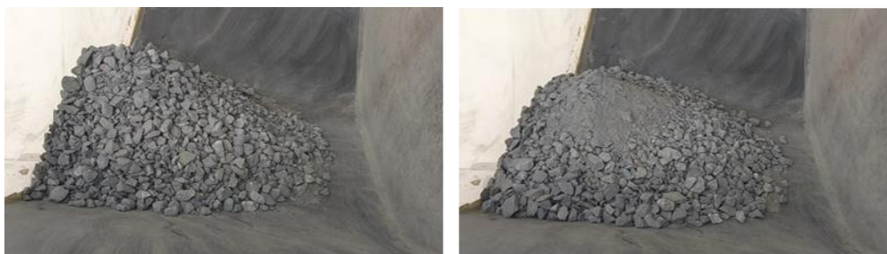
Figura 6-26: Ensayo de ángulo máximo de inclinación para el mineral chancado de hierro. Inclinación de 7^\circ para 3 m/s y 400 m de longitud.
