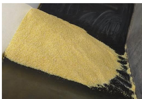
Figura 6-5: Ensayo de ángulo máximo de inclinación para el grits de maíz. Inclinación de 22^\circ para 2 m/s y 250 m de longitud.
