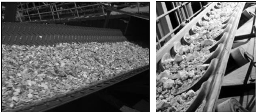
Figura 3-4: Ejemplos de bandas con separadores moldeados [18].
