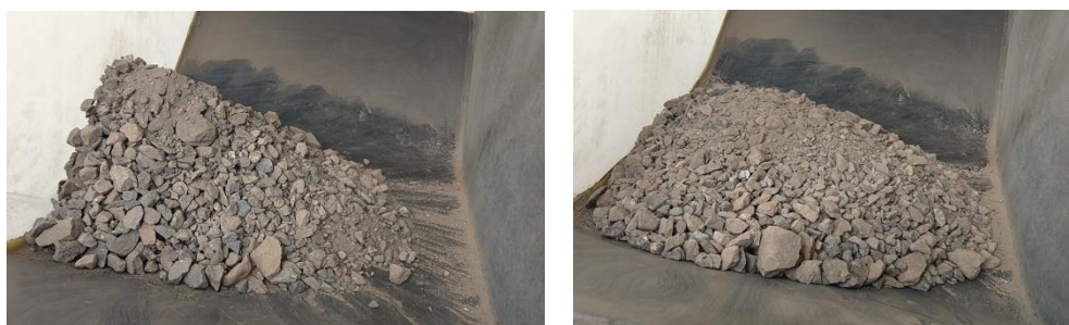
Figura 6-20: Ensayo de ángulo máximo de inclinación para el mineral chancado de cobre. Inclinación de 7° para 3 m/s y 400 m de longitud.
