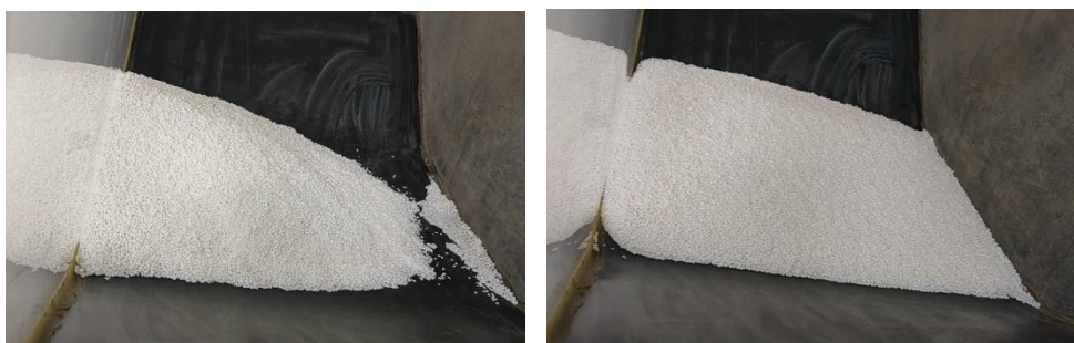
Figura 6-11: Ensayo de ángulo máximo de inclinación para el fertilizante. Inclinación de 15^{\circ} para 2 m/s y 250 m de longitud.
