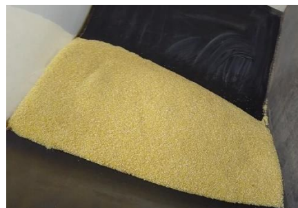
Figura 6-4: Ensayo de ángulo máximo de inclinación para el grits de maíz. Inclinación de 21^\circ para 2 m/s y 250 m de longitud.
