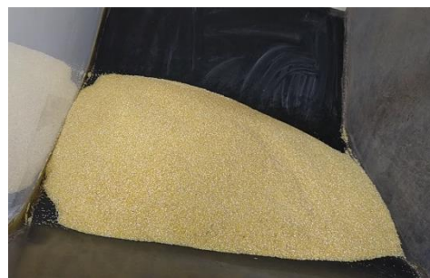
Figura 6-7: Ensayo de ángulo máximo de inclinación para el grits de maíz. Inclinación de 16^\circ para 3 m/s y 400 m de longitud.
