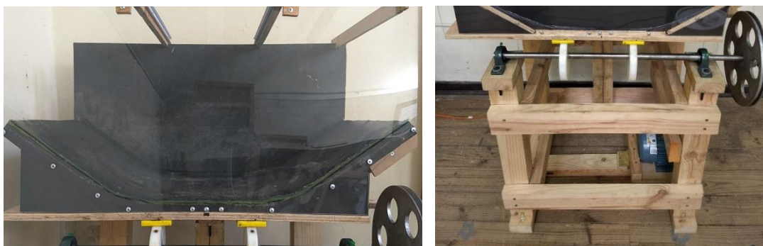
Figura 5-7: Cajón de banda de 1050 mm (42'') de ancho y estructura base.
