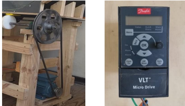
Figura 5-8: Motor eléctrico trifásico a la izquierda y el variador de frecuencia a la derecha.
