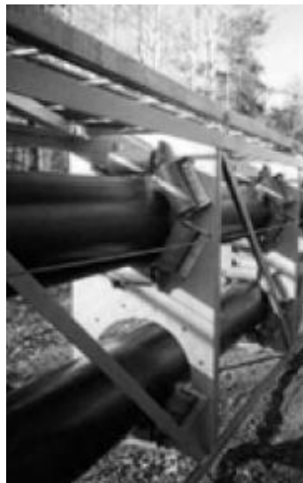
Figura 3-7: Configuración hexagonal de polines para banda tubular [20].
