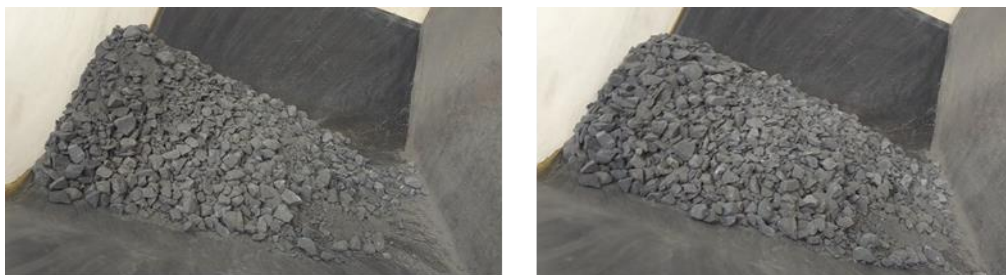
Figura 6-24: Ensayo de ángulo máximo de inclinación para el mineral chancado de hierro. Inclinación de 19^\circ para 2 m/s y 250 m de longitud.
