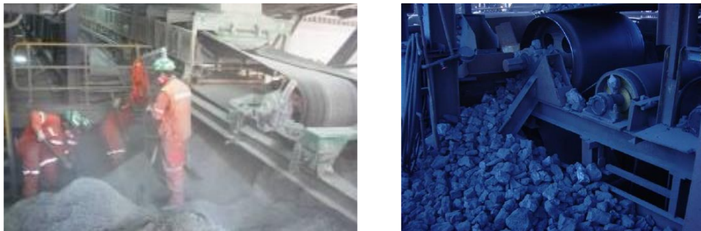
Figura 1-2: Derrame de material [6].
