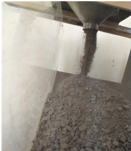
Figura 5-11: Carga de mineral chancado de hierro.
