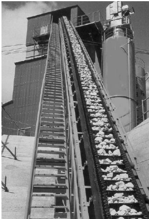
Figura 3-5: Pockit belt típico para elevación inclinada [19].
