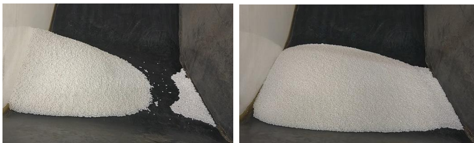
Figura 6-13: Ensayo de ángulo máximo de inclinación para el fertilizante. Inclinación de 8^{\circ} para 3 m/s y 400 m de longitud.
