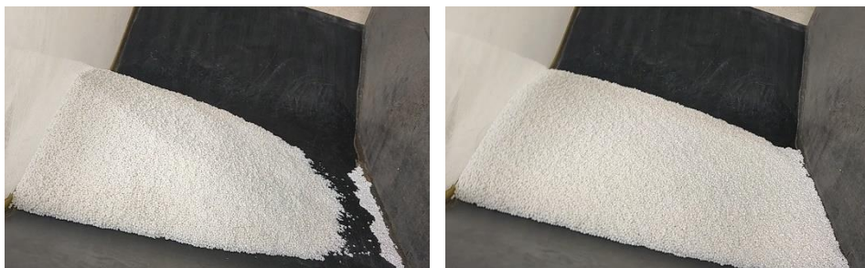
Figura 6-10: Ensayo de ángulo máximo de inclinación para el fertilizante. Inclinación de 14^{\circ} para 2 m/s y 250 m de longitud.
