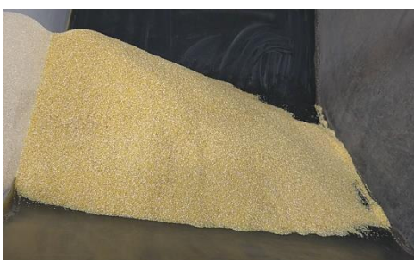
Figura 6-6: Ensayo de ángulo máximo de inclinación para el grits de maíz. Inclinación de 15^\circ para 3 m/s y 400 m de longitud.
