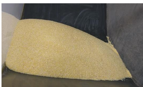
Figura 6-6: Ensayo de ángulo máximo de inclinación para el grits de maíz. Inclinación de 15^\circ para 3 m/s y 400 m de longitud.
