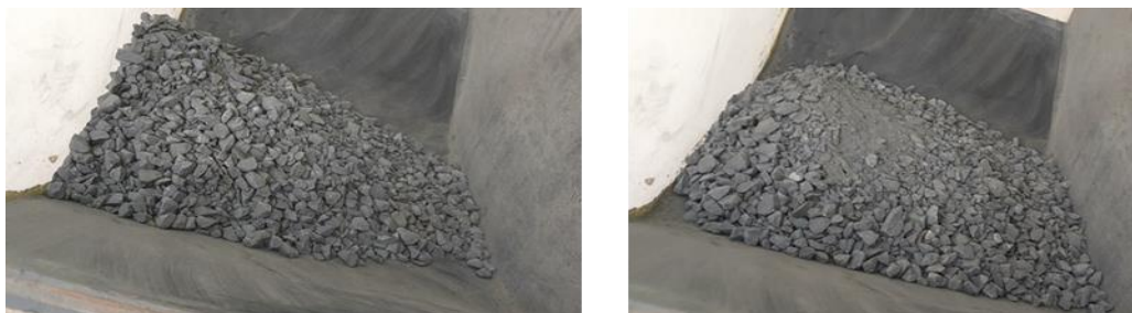
Figura 6-25: Ensayo de ángulo máximo de inclinación para el mineral chancado de hierro. Inclinación de 20^\circ para 2 m/s y 250 m de longitud.
