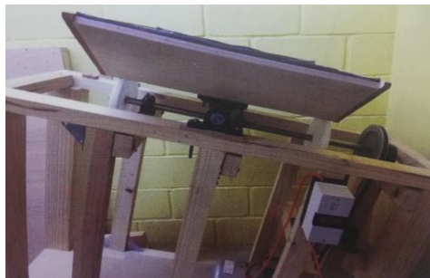
Figura 4-3: Modelo físico para estudiar la transportabilidad sobre una correa. Jenike and Johanson Chile [32].
