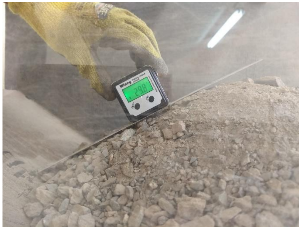
Figura 5-12: Medición del ángulo de sobrecarga con inclinómetro para el mineral chancado de cobre.
